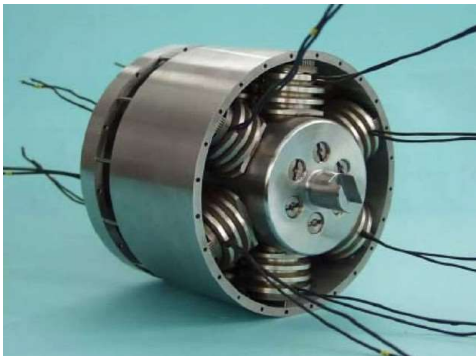
Рис. 3. Магнитострикционный привод, разработанный компанией Saab Dynamic AB, с 12 штоками из Терфенола-D. Фото из книги: Mohsen Torabzadeh-Tari. Analysis of Electro-Mechanical Actuator Systems in More Electric Aircraft Applications. Stockholm, 2005.
