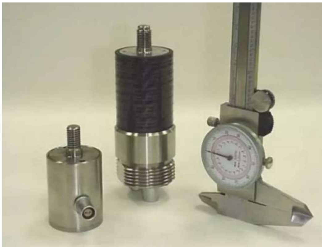
Рис. 2. Примеры использования Терфенола-Д в магнитострикционных преобразователях. Фото из статьи: Pinkham M. Etrema Products Inc. Finds Success with TERFENOL-D // Elements. 2001, V. 2, N. 123, P. 4–6.
