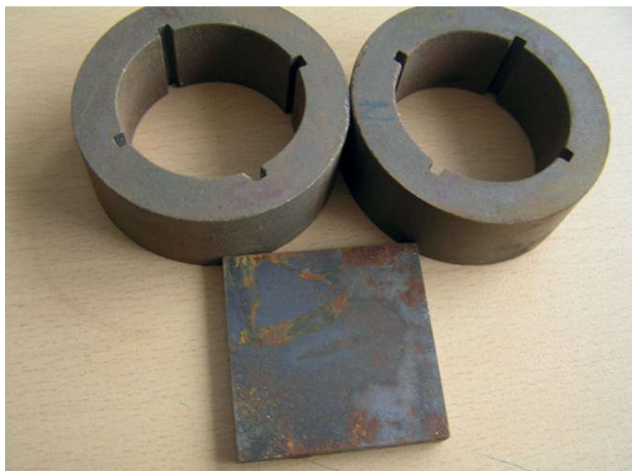
Рис. 1 Коррозия магнитов из сплава ЮНДК (кольца) и NdFeB (блок) при эксплуатации
