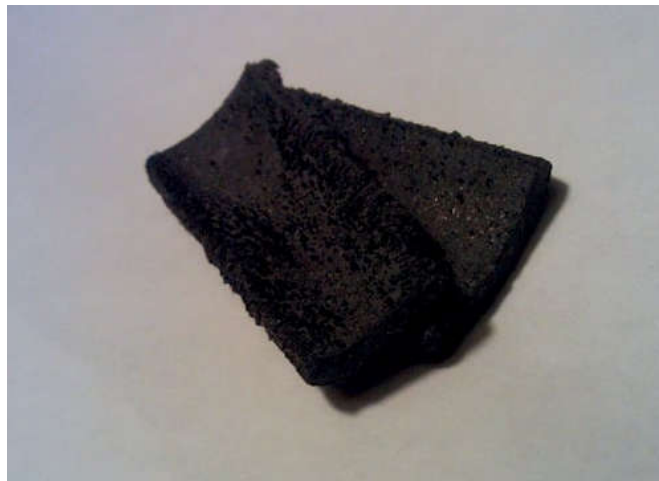
Рис. 2 Разрушение магнита из сплава SmCo после 1 года эксплуатации в морской воде.
