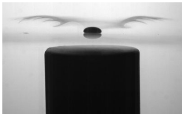
Рис. 2 Капля жидкого кислорода, парящая на подушке из пара над поверхностью магнита
