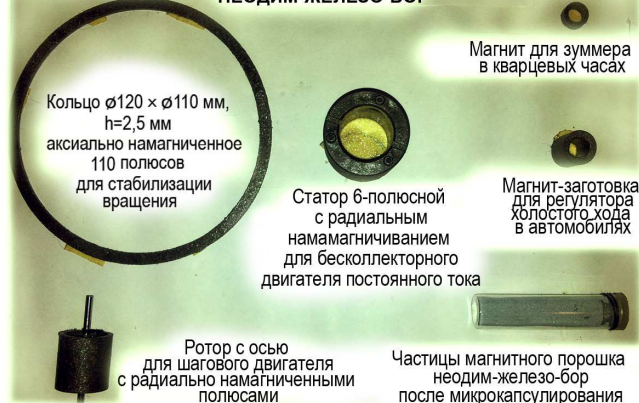
Рис. 4. Магнитные детали для часовой и автомобильной промышленности.
