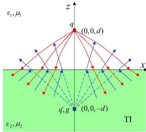
Рис.6 Схема наблюдения магнитного монополя
