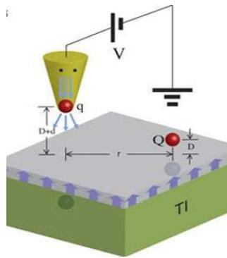
Рис.7 Предполагаемая схема экспериментального детектирования монополя с помощью иглы магнитного силового микроскопа.
