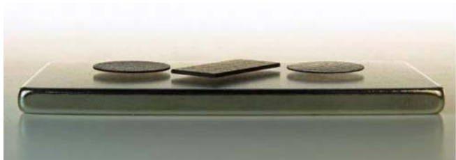
Левитация пластин пиролитического графита над постоянным магнитом с «напечатанными» доменами
