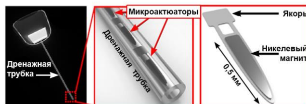
Дренаж с магнитными актюаторами (длина ~ 0.5 мм) [1]
