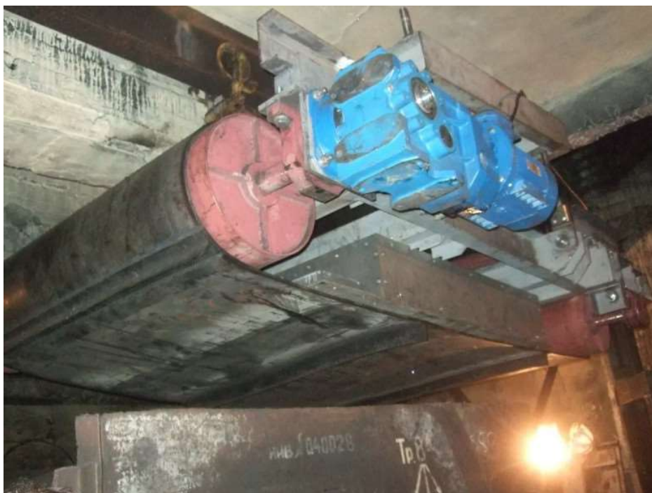
Рис. 4. Магнитный сепаратор над угольным конвейером на Черепетской ГРЭС Тульской области [производство ООО «ПМТиК» (группа АМТ&С)].
