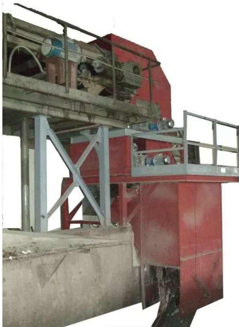
Рис. 2. Двухбарабанный магнитный сепаратор с системой подачи и выгрузки на мусоросортировочном заводе в Котляково [производство компании ООО «ПМТиК» (группа АМТ&С)].
